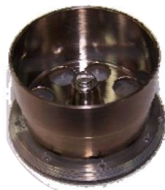
شکل (۲): بخش مکانیک ژيروسکوپ ارتعاشی مدور
