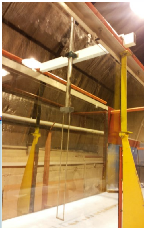
شکل ۱۳- نمایی از ماژول ۸ کاناله، سنسور ثبت ارتفاع موج و نرم‌افزار تحلیل داده‌ها
