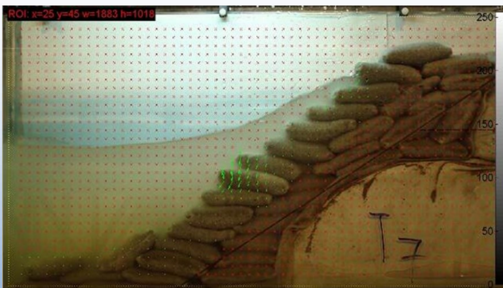
شکل ۴- نمایی از برخورد امواج از مقطع موج‌شکن با پوشش ژئوبگ
