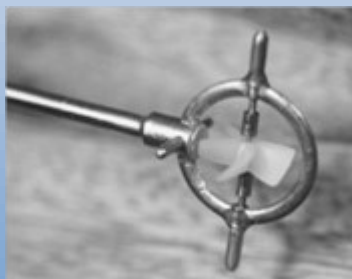
شکل ۱۹- نمایی از دستگاه سرعت سنج نقطه‌ای
