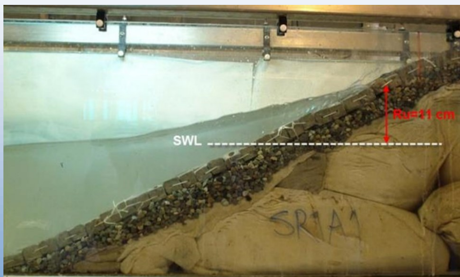
شکل ۶- نمایی از بالاروی امواج از مقطع موج‌شکن با پوشش بلوک‌های بتنی به هم پیوسته
