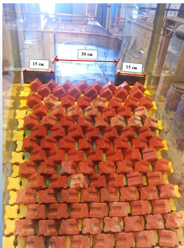
شکل ۳- محل جانمایی سیستم اندازه گیری میزان روگذری امواج و نمایی از چیدمان بلوکها
