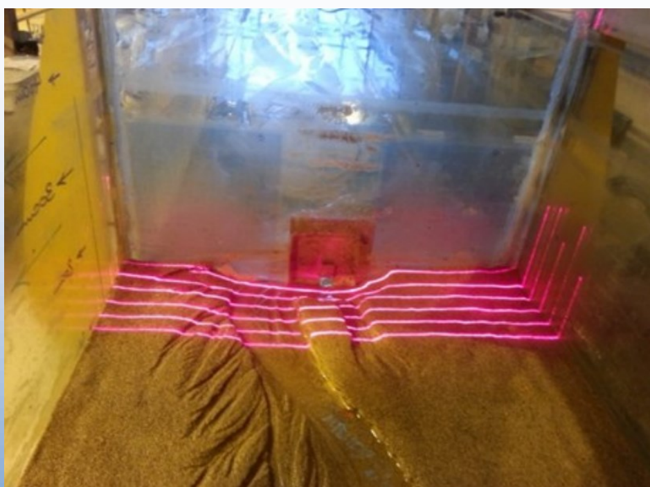
شکل ۱۰- نمایی از مدل‌سازی تخلیه رسوب مخزن سد
