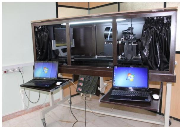
میز تست سامانه ستاره‌یاب نصیر ۱ - دانشکده مهندسی هوافضا
